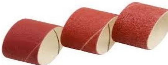
I manicotti sono fatti di strisce di tela abrasiva, avvolta ed incollata su un supporto di cotone, ideali per la rettifica di alluminio o acciaio, da usare con porta manicotti in gomma, i quali si espandono per la azione della forza centrifuga fissando il manicotto
